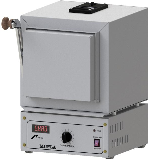
Diseñada para una gran variedad de aplicaciones, incluyendo trabajos de laboratorio, procesos a temperatura controlada, tratamientos térmicos, secado y calcinación de precipitados, ensayos de fundición. Con control analógico e indicador digital de temperatura. Rango de temperatura hasta 1,100 °C. fabricada en una sola medida.
