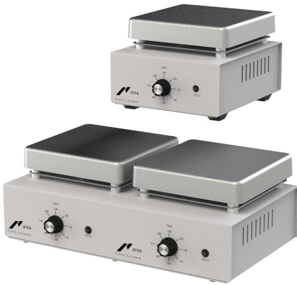
Plancha de aluminio que por ser un gran conductor del calor proporciona una excelente uniformidad térmica en toda la superficie del plato. Su elemento calefactor tipo blindado e integrado a presión en la plancha ofrece una eficiente transferencia del calor y una vida útil más larga que otros equipos. Temperatura máxima 400 °C. Medidas de la plancha: 13.6 cm x 13.6 cm.
