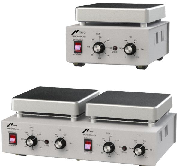
Recomendado para todo tipo de laboratorios donde se requiere de una eficiente agitación y un rápido calentamiento. Plato construido en aluminio, diseñado para operar a 400 °C y una velocidad máxima de agitación de 1,500 r.p.m. Panel frontal con luz piloto, elemento calefactor tipo blindado e integrado a presión en la plancha. Medidas del plato: 13.6 cm x 13.6 cm. 120 Volts. Dos modelos a elegir:
